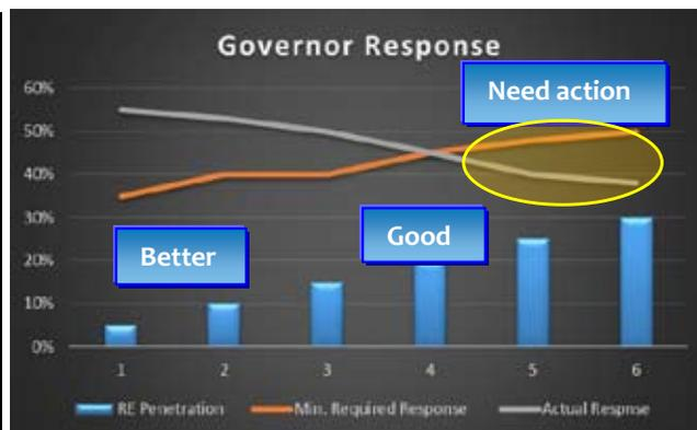
Fig. 6 : Grid code parameter monitoring
